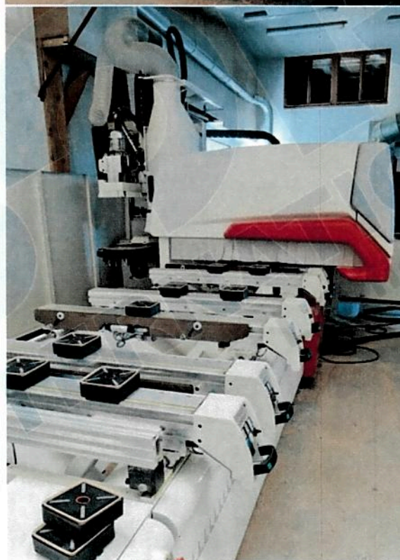
La nouvelle acquisition de Michaël Taillard : La SCM tech z5 5 axes.
